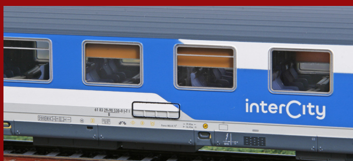
Carrozza di 2ª classe "Intercity giorno" nella nuova livrea con fascia blu, senza pannello indicatore del percorso. Nuova numerazione. Passenger car 2 nd class "Intercity giorno" in new livery with a blue stripe, without direction indicator. New numbering. Personenwagen 2. Klasse „Intercity giorno“ in neuer Lackierung mit blauem Streifen, ohne Fahrtrichtungsanzeige. Neue Nummerierung.
