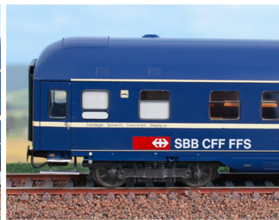
Carrozza letti WLABmh 174 in livrea blu TEN delle Ferrovie Svizzere con carrelli München-Kassel. Sleeping car WLABmh 174 in TEN blue livery of the Swiss Railways with München-Kassel bogies. Schlafwagen WLABmh 174 in blauer TEN-Lackierung der Schweizerischen Bundesbahnen mit Drehgestellen München-Kassel.
