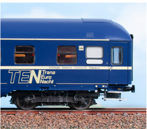
Carrozza letti WLABmh 174 in livrea blu TEN delle Ferrovie Svizzere con carrelli München-Kassel. Sleeping car WLABmh 174 in TEN blue livery of the Swiss Railways with München-Kassel bogies. Schlafwagen WLABmh 174 in blauer TEN-Lackierung der Schweizerischen Bundesbahnen mit Drehgestellen München-Kassel.
