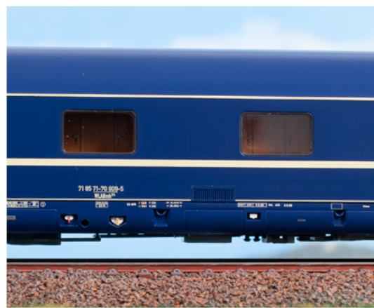
Carrozza letti WLABmh 174 in livrea blu TEN delle Ferrovie Svizzere con carrelli München-Kassel. Sleeping car WLABmh 174 in TEN blue livery of the Swiss Railways with München-Kassel bogies. Schlafwagen WLABmh 174 in blauer TEN-Lackierung der Schweizerischen Bundesbahnen mit Drehgestellen München-Kassel.
