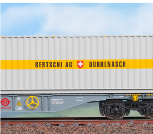
Carro intermodale Tipo Sgnss Ermewa da 60 piedi caricato con due bulk container da 30 piedi "Cogefrin" e "Bertschi". Container wagon Type Sgnss '60 Ermewa with "Cogefrin" and "Bertschi" bulk containers. 60-Fuß-Intermodalwagen vom Typ Sgnss Ermewa, beladen mit zwei 30-Fuß-Bulk "Cogefrin" und „Bertschi“.
