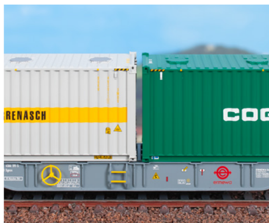
Carro intermodale Tipo Sgnss Ermewa da 60 piedi caricato con due bulk container da 30 piedi "Cogefrin" e "Bertschi". Container wagon Type Sgnss '60 Ermewa with "Cogefrin" and "Bertschi" bulk containers. 60-Fuß-Intermodalwagen vom Typ Sgnss Ermewa, beladen mit zwei 30-Fuß-Bulk "Cogefrin" und „Bertschi“.
