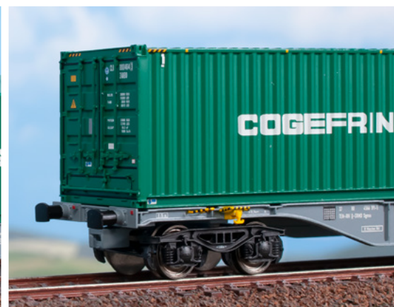
Carro intermodale Tipo Sgnss Ermewa da 60 piedi caricato con due bulk container da 30 piedi "Cogefrin" e "Bertschi". Container wagon Type Sgnss '60 Ermewa with "Cogefrin" and "Bertschi" bulk containers. 60-Fuß-Intermodalwagen vom Typ Sgnss Ermewa, beladen mit zwei 30-Fuß-Bulk "Cogefrin" und „Bertschi“.
