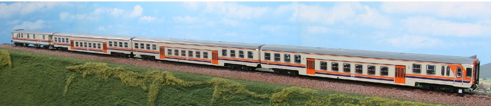
Treno regionale FS Tipo 1973 a piano ribassato, formato da un bagagliaio Tipo 1978R, due vetture di 2a classe e una vettura pilota. Livrea MDVC.
