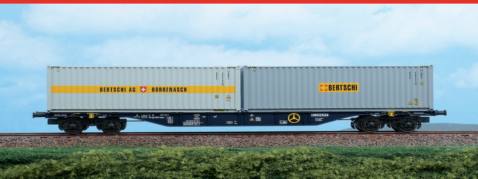
Carro intermodale Tipo Sgnss CEMAT da 60 piedi caricato con due bulk container da 30 piedi "BERTSCHI". Container wagon Type Sgnss '60 CEMAT with two "Bertschi" bulk containers. 60-Fuß-Intermodalwagen vom Typ Sgnss CEMAT, beladen mit zwei 30-Fuß-Bulk "Bertschi".
