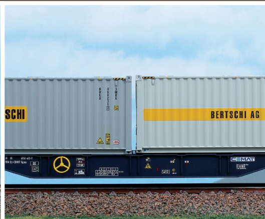
Carro intermodale Tipo Sgnss CEMAT da 60 piedi caricato con due bulk container da 30 piedi "BERTSCHI". Container wagon Type Sgnss '60 CEMAT with two "Bertschi" bulk containers. 60-Fuß-Intermodalwagen vom Typ Sgnss CEMAT, beladen mit zwei 30-Fuß-Bulk "Bertschi".
