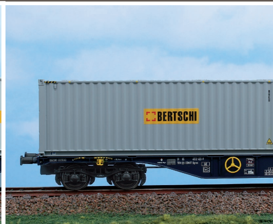
Carro intermodale Tipo Sgnss CEMAT da 60 piedi caricato con due bulk container da 30 piedi "BERTSCHI". Container wagon Type Sgnss '60 CEMAT with two "Bertschi" bulk containers. 60-Fuß-Intermodalwagen vom Typ Sgnss CEMAT, beladen mit zwei 30-Fuß-Bulk "Bertschi".
