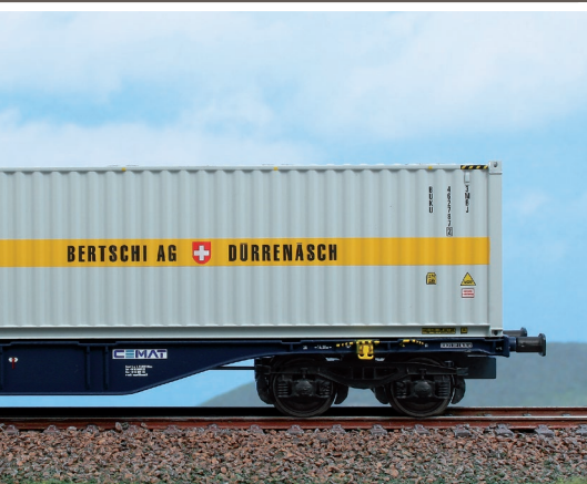
Carro intermodale Tipo Sgnss CEMAT da 60 piedi caricato con due bulk container da 30 piedi "BERTSCHI". Container wagon Type Sgnss '60 CEMAT with two "Bertschi" bulk containers. 60-Fuß-Intermodalwagen vom Typ Sgnss CEMAT, beladen mit zwei 30-Fuß-Bulk "Bertschi".
