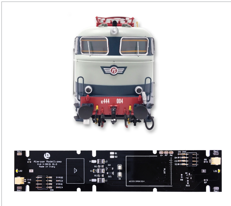
Cod.4-30131 Main board per ACME E444 connettore decoder PLUX22
