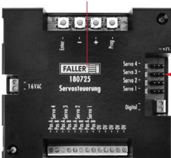
Den Servo mittels Steuerung 180725 gegen den Uhrzeigersinn bis zum
