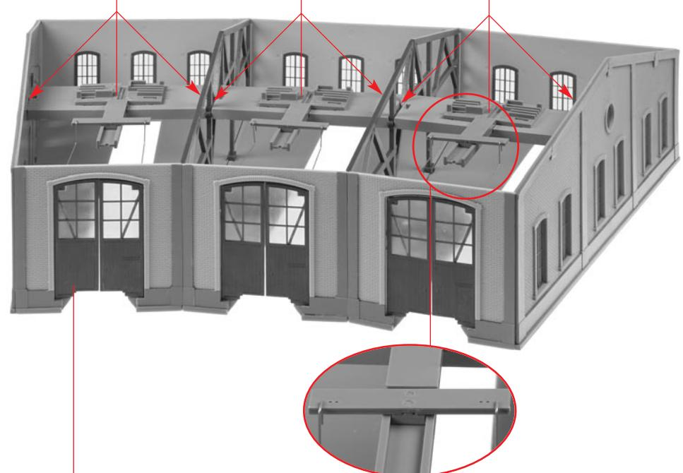
Falls die Türen nicht exakt schließen, können die Drähte in den Löchern versetzt werden.
