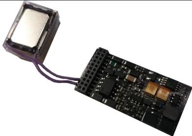
Per facilitare le operazioni di installazione, il decoder viene fornito con altoparlante già saldato.
