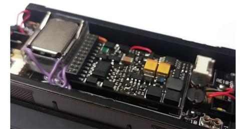
locomotore. Verificare l'esatto allineamento dei pin. Un posizionamento errato può distruggere irrimediabilmente il decoder.
