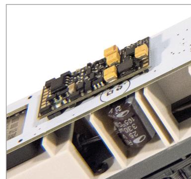
figura 9 - posizionamento del condensatore
