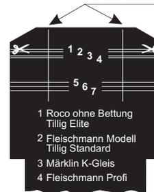
Markierung für die Fahrdrabthöhe der verschiedenen Gleistypen
