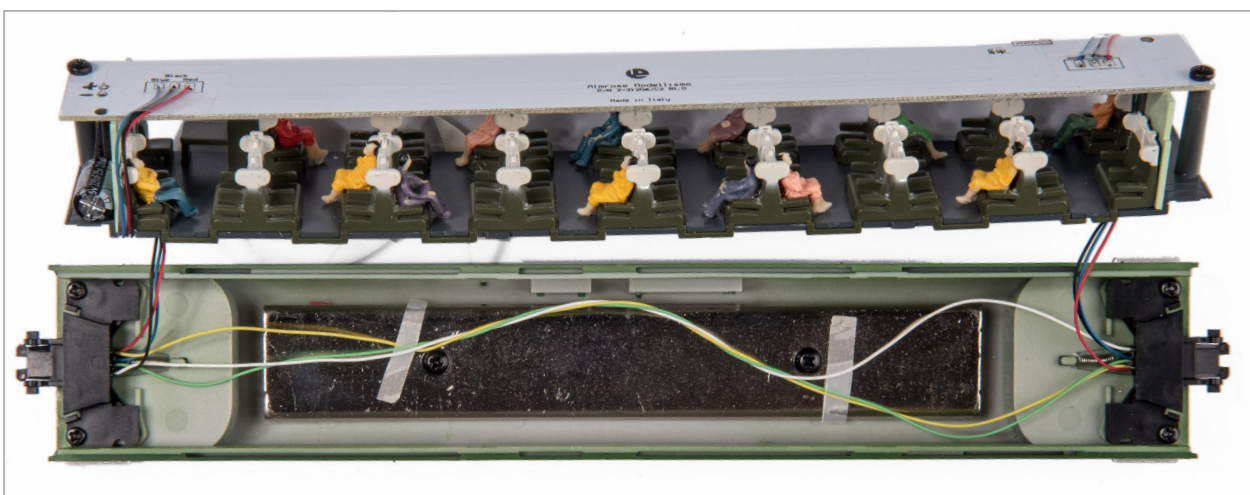
fig.27 carrozza 2: la scheda luci montata con i fili saldati
