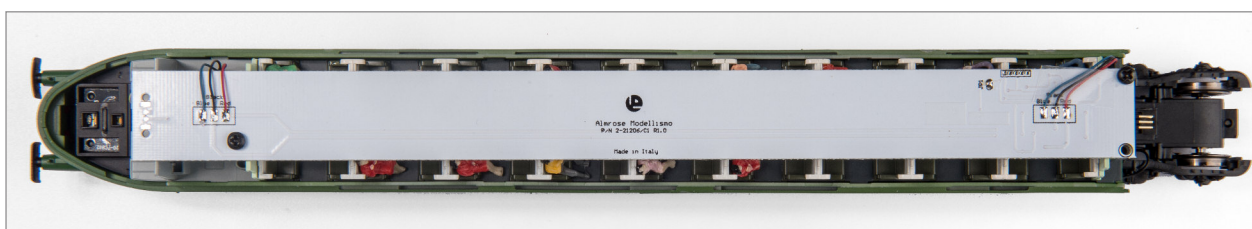
fig.9 carrozza 1: la scheda luci montata
