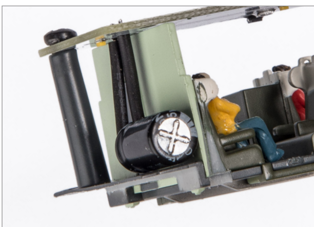
fig.25 carrozza 2: il condensatore posizionato
