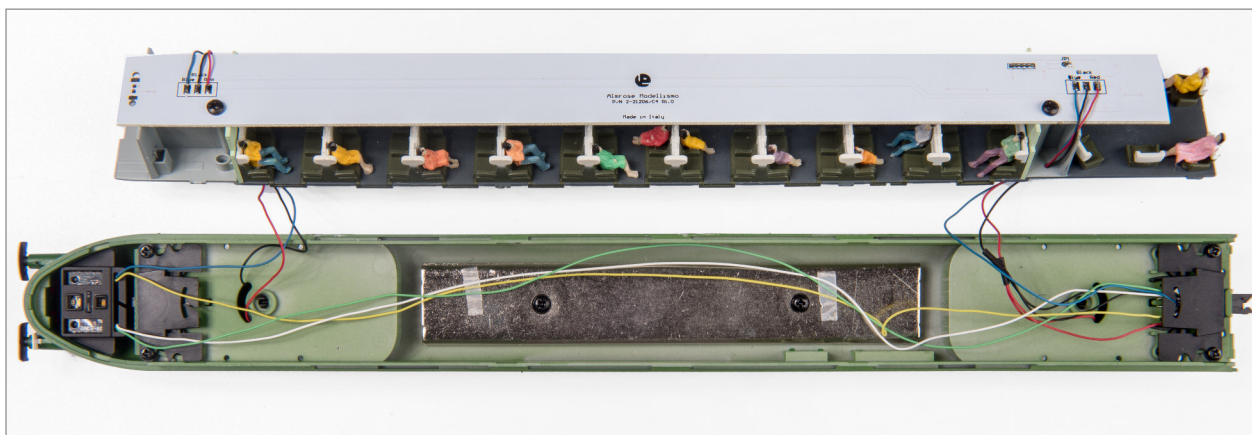
fig.14 carrozza 4: la scheda luci montata con i fili saldati
