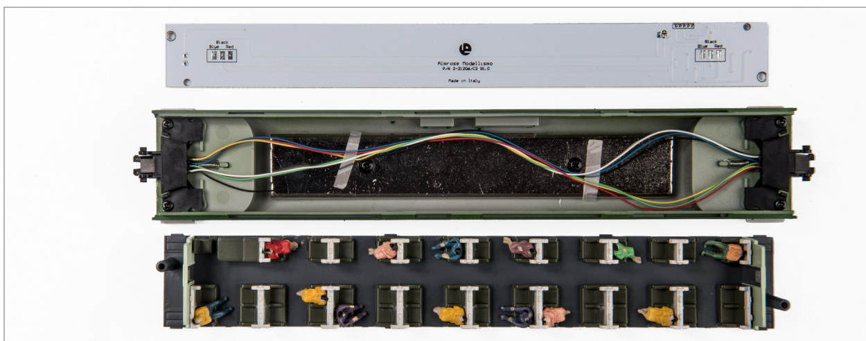
fig.20 carrozza 2: aperta con i fili rosso, nero e blu tagliati e con la scheda luci ancora da montare
