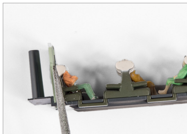
fig.24 carrozza 2: posizione di dove con la lima effettuare lo scasso
