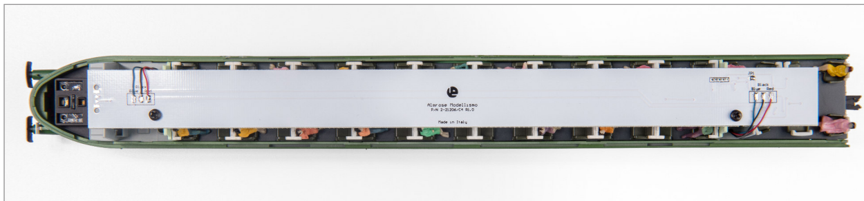
fig.17 carrozza 4: la scheda luci montata
