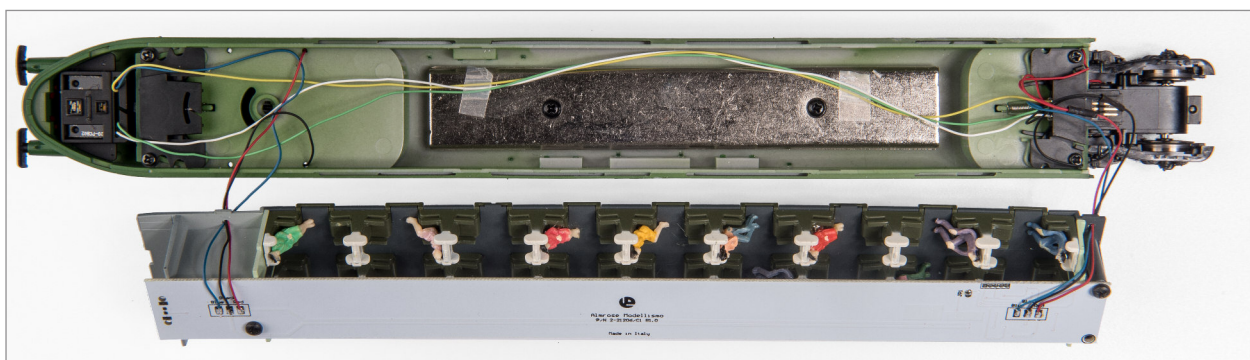
fig.6 carrozza 1: la scheda luci montata con i fili saldati
