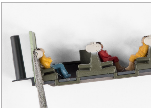
fig.23 carrozza 2: posizione di dove con la lima effettuare lo scasso
