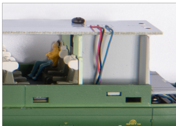
fig.19 carrozza 4: particolare passaggio fili
