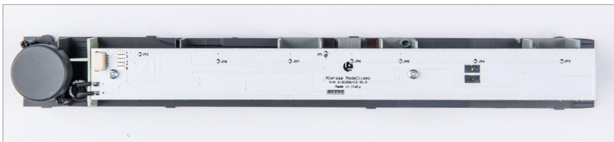
fig.40 carrozza3: la scheda luci montata
