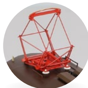
nuovi pantografi 42LR con strisciante curvo
