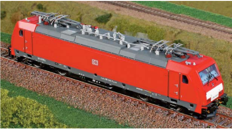
Locomotiva politemensione E 186 340 di DB Schenker per i treni internazionali tra Belgio, Germania, Francia. Multi System E 186 340 DB Schenker used for goods trains between Belgium, Germany and France. E-lok E 186 340 der DB Schenker für internationale Güterzüge zwischen Belgien, Deutschland und Frankreich.
