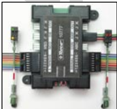
Abbildung 1 Das Lichtsignalmodul 10777 mit zwei angeschlossenen Lichtsignalen
